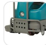
Schützen Sie die T16 vor Kontaktschäden mit der optionalen **Frontstoßstange für extreme Umgebungen**.
